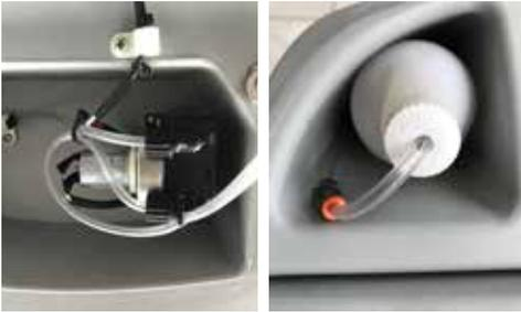
Trion 4050 può essere equipaggiata di serie del sistema di regolazione del detergente la cui percentuale (fissa con 4 valori: 0,2%-0,5%-1%-1,5%) è impostata dal display con una semplice operazione. Cio' consente una precisa calibrazione della quantità di prodotto chimico in funzione dell'applicazione. Si evitano quindi sia sprechi di detergente rispetto alla dosatura manuale nel serbatoio dell'acqua che ristagni di prodotto nel serbatoio.
