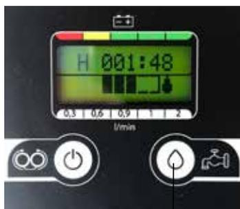
Pulsante regolazione acqua da 0,3 a 2 l/min. Lo stesso pulsante consente di scaricare il serbatoio della soluzione
